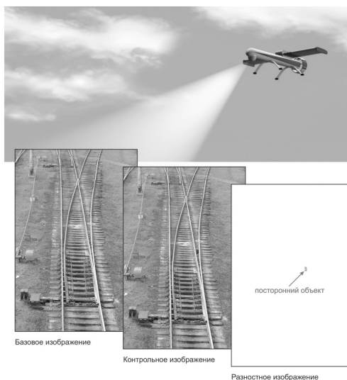
Рис. 1. Обследование железнодорожного пути с помощью установленных на ДПЛА оптических датчиков.
