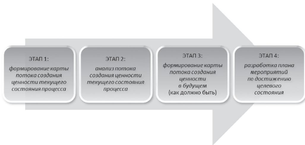
Рис. 2. Последовательность этапов применения инструмента картирования.
