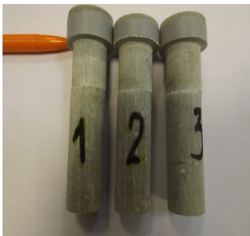
Рис. 4. Образцы композитных валиков после испытаний.
