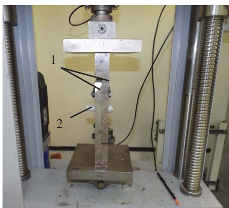
Рис. 2. Схема испытаний на одинарный срез: 1 – ножи; 2 – образец.
