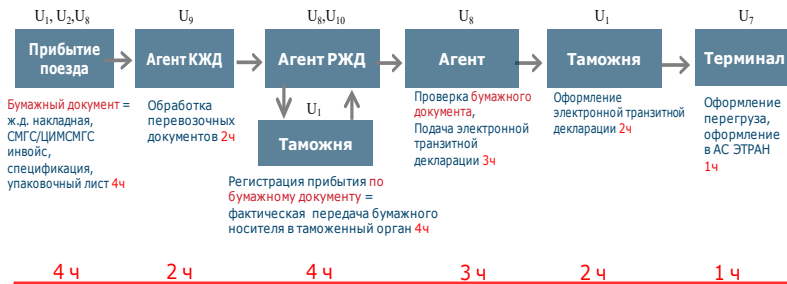
Рис. 5. Существующая модель обработки документального и информационного потоков контейнерного поезда на ЖДПП Забайкальск.
