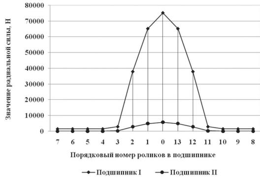
Рис. 5. График распределения радиальных сил на ролики в подшипниках буксового узла с внешней стороны радиуса кривого участка пути (асимметричное приложение сил).
