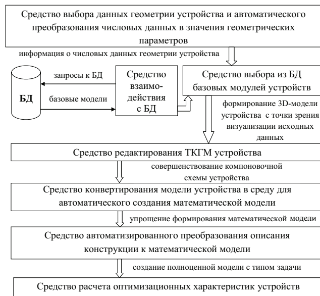
Рис. 2. Способ построения ТКГМ и оптимизации параметров моделируемых устройств.
