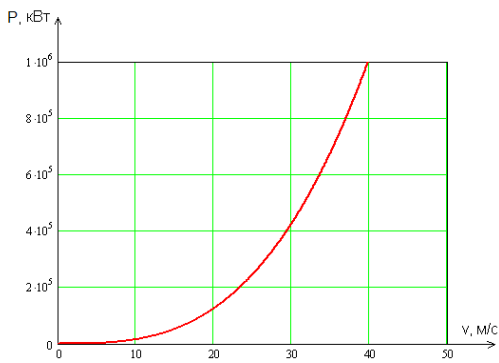
Рис. 7. Зависимость потребляемой мощности от скорости движения для судна каплевидной формы с традиционным двигателем (винтом) водоизмещением 4000 т.
