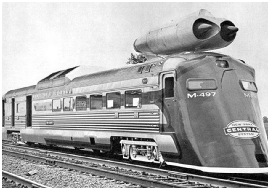
Experimental M-497 turbojet train («Black Beetle», 1966), USA.
