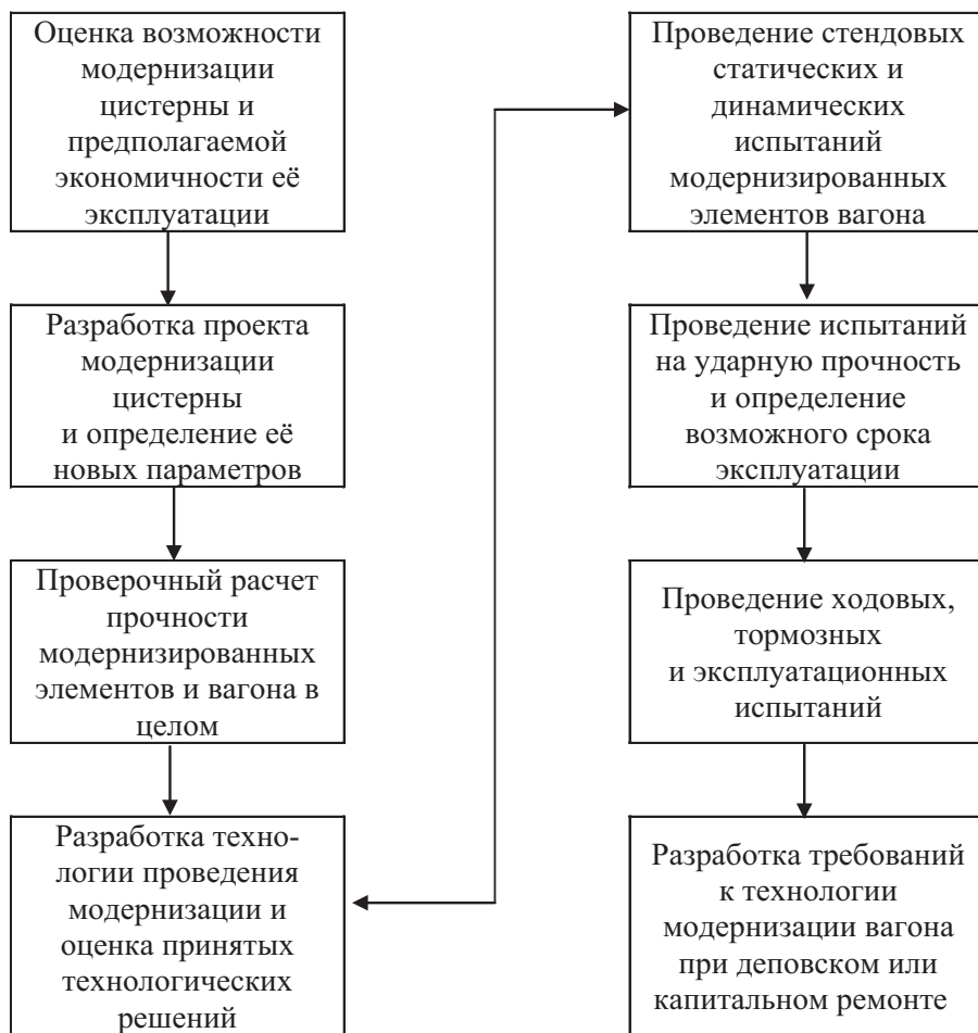
Рис. 1. Блок-схема методики оценки работоспособности модернизированного котла вагона-цистерны.
