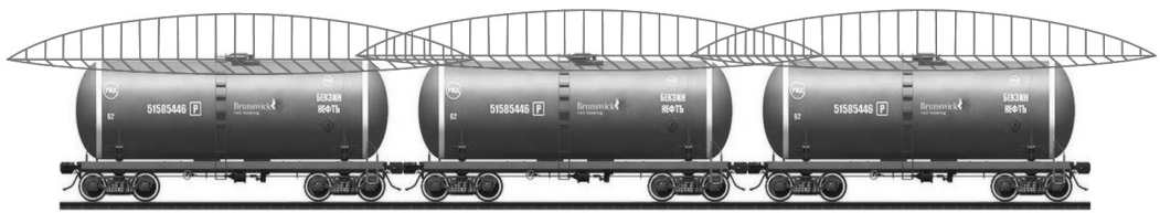
Рис. 2. Схема перекрытия соседних взрывоопасных зон.
