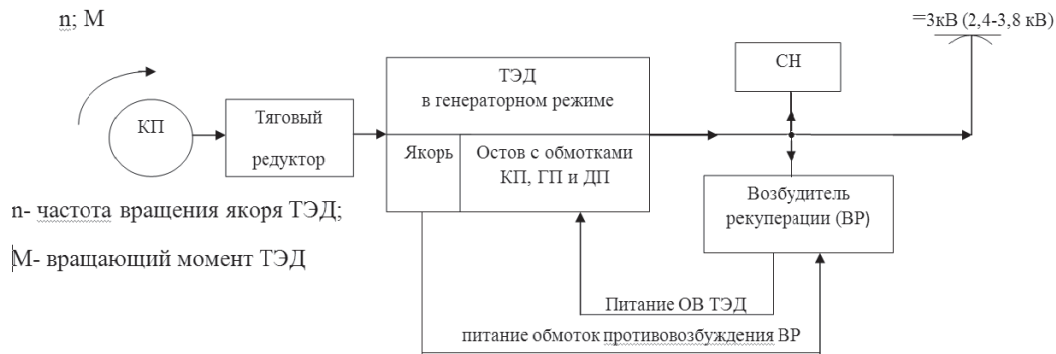
Рис. 1. Схема энергетической цепи электровоза (КП—колесная пара; СН—собственные нужды, т. е. нетяговые потребители).
