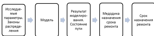
Рис. 1. Схема управления планированием ремонта пути на основе разработанных методики и модели.
