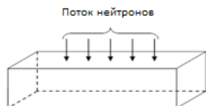
Рис. 3. Схема облучения заготовки из графита.
