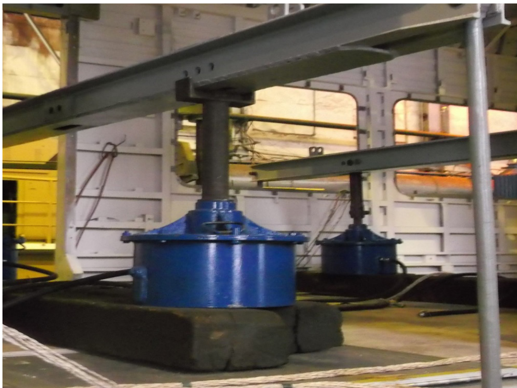
Рис. 3. Реализация вертикальной нагрузки на металлоконструкцию кузова вагона с помощью пневмооборудования.
