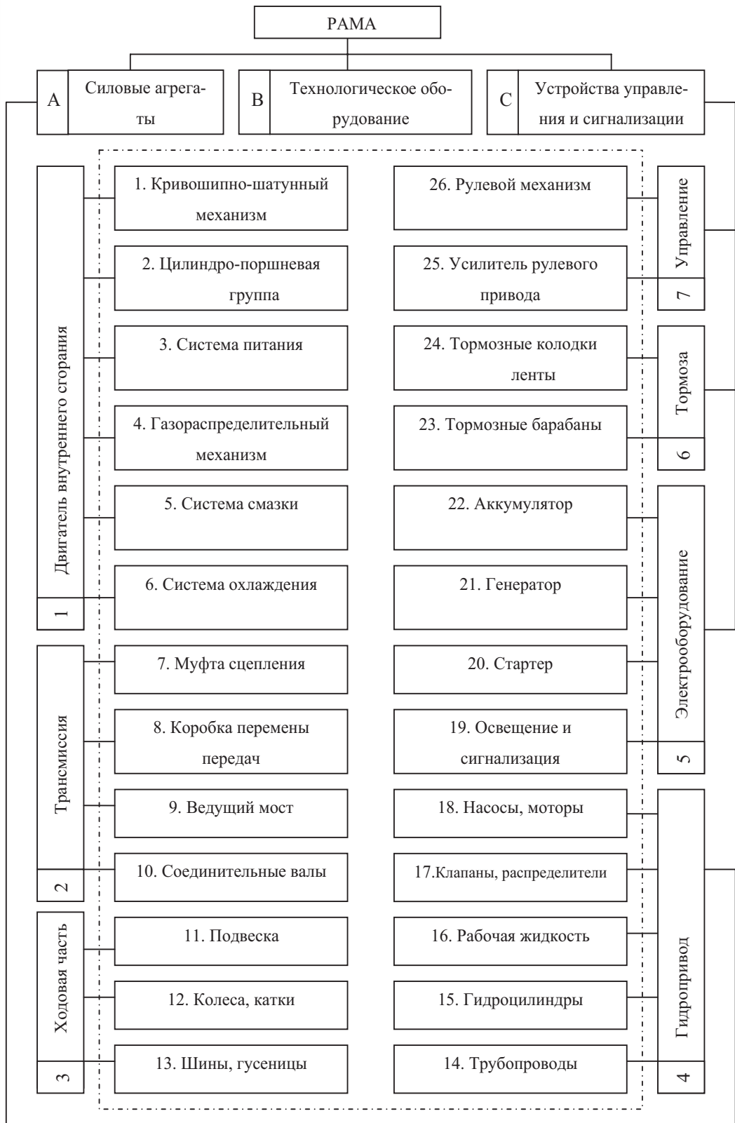
Рис. 1. Структурная схема обобщенной машины.
