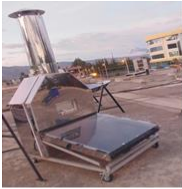
Fig.5. Prototipo de secador solar.
