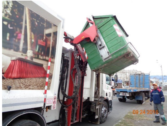
Figura 1. Vehículo de carga lateral usado en Ambato
