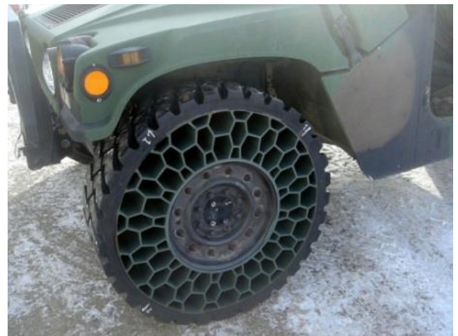
Gambar 26. Model ban anti bocor versi militer tanpa udara dirancang dengan struktur fraktal (Sumber: http://airless-tire-ban-tanpa-perlu-angin )
