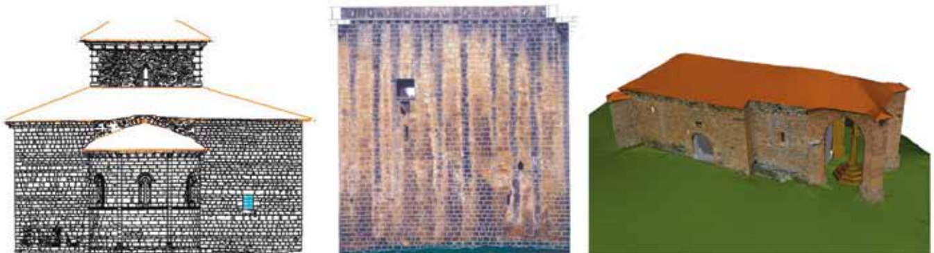
Figura 1.- Ejemplos de los tres tipos de productos fotogramétricos comentados, de izquierda a derecha: despiece vectorial obtenido por restitución estereoscópica (LDGP 2004), rectificación fotográfica (LDGP 2002) y modelo 3D con textura fotográfica (LDGP 2008).
