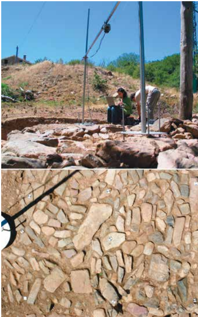
Figura 20.- En la imagen superior se muestra la estructura de sujeción de la cámara para la toma de pares cenitales del empedrado del suelo del puente de la Venta de Piqueras en Lumbreras (La Rioja). La imagen inferior corresponde a una de las fotografías del par en la cual aparece uno de los pies de la estructura y su sombra (LDGP 2005b).
