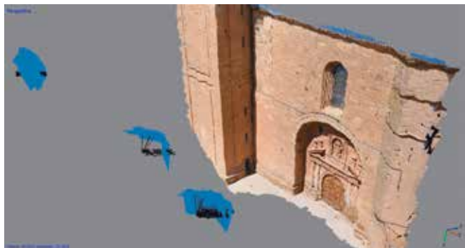
Figura 16.- Resultado del procesado de los pares, en el que se muestran las tres posiciones desde las que se obtuvieron los pares. También se aprecia que las texturas aparecen claramente deformadas en algunas zonas.
