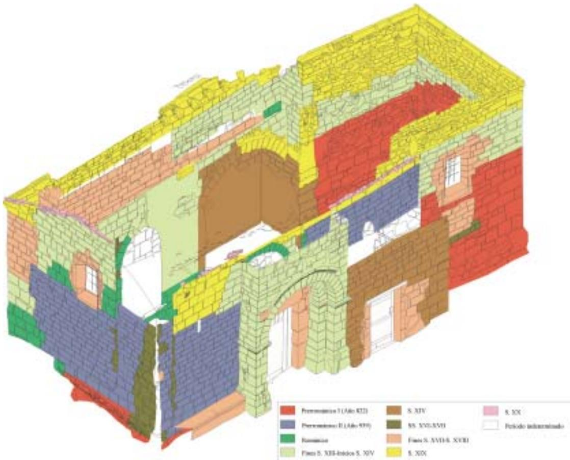
Fig.6. Fases constructivas de la iglesia de San Román de Tobillas (Fotogrametría de L. Cámara y P. Latorre)
