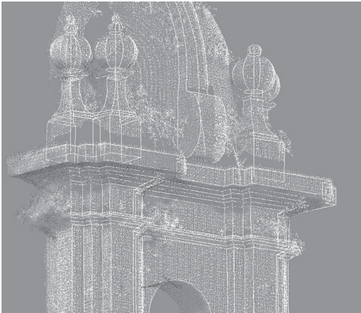
Fig. 6. Dibujo en AutoCad con el programa Cloudworx de los volúmenes generales de una estructura sobre una nube de puntos visualizada a baja densidad
