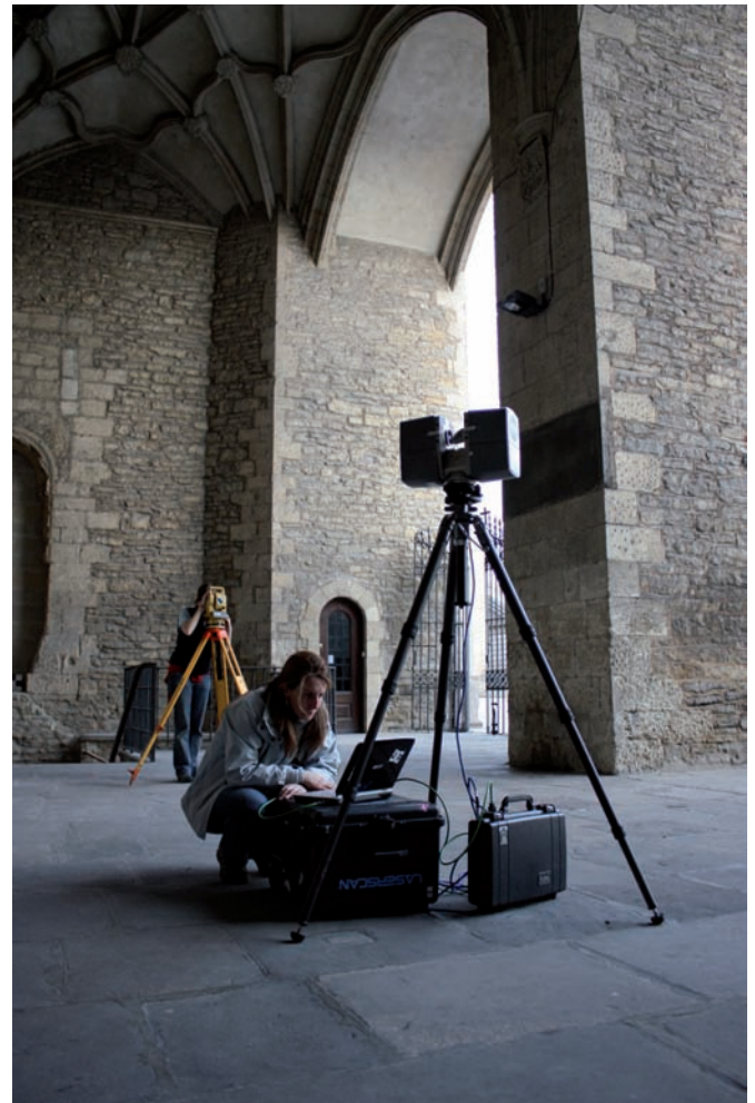
Fig. 11. Escaneado y observación de las referencias con estación total en el pórtico de San Miguel
