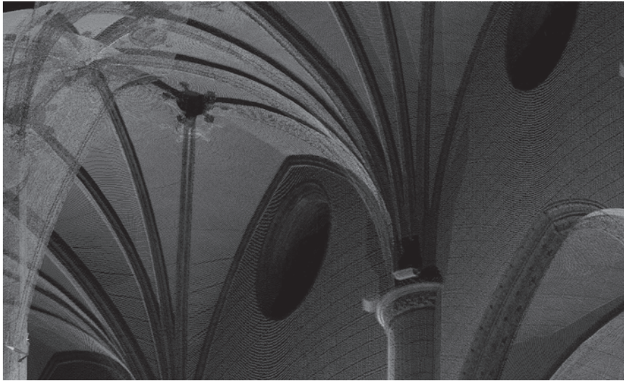
Fig. 3. Detalle del modelo de San Miguel en el cual puede observarse la trama de la nube de puntos
