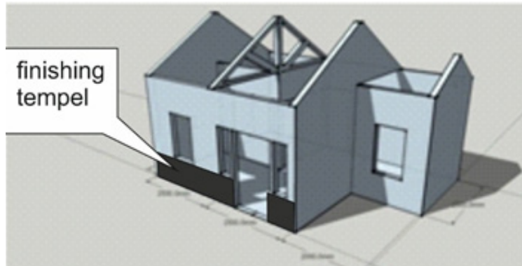
Gambar 5. Finishing tempel sebagian (keramik / batu pipih)
