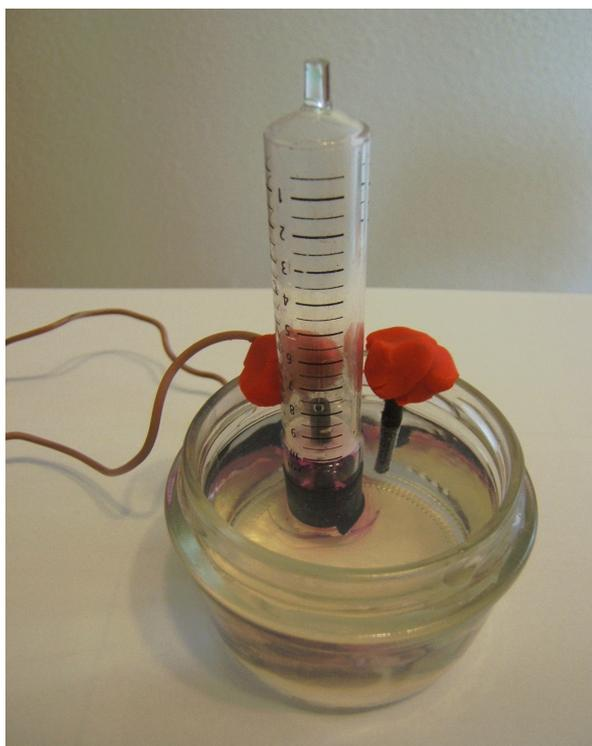
**Figura 10.-** *Electrólisis de agua usando una jeringuilla para recoger el hidrógeno generado en el cátodo.*
