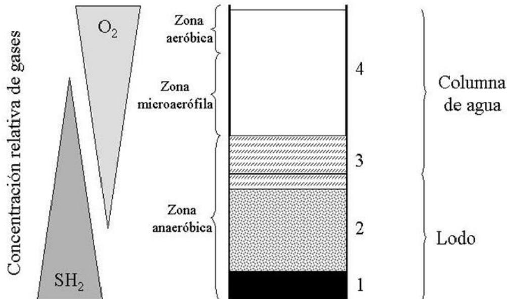
**Figura 1.-** Dibujo esquemático de la construcción de una columna de Winogradsky<sup>1</sup>.
