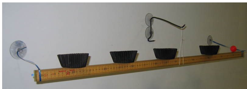
Figura 2. Configuración para soltar en forma simultánea los moldes de papel de papel apilados.
