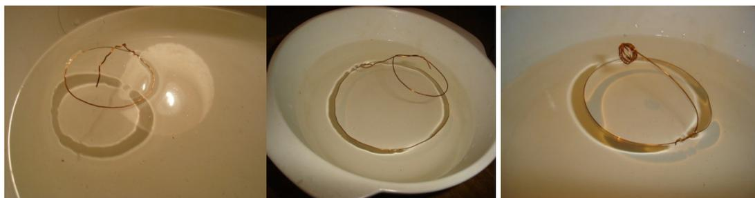
Figura 6. Arreglo experimental para medir la fuerza F.
