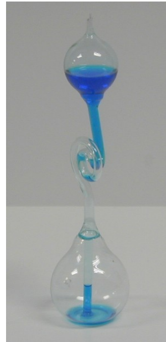
Figura 3. Hervidor de mano ( hand boiler , en inglés). Con el líquido en su bulbo inferior, si éste se cubre con la mano, el líquido se evapora, aumenta su presión, y asciende por el tubo que conecta ambos bulbos, manteniéndose en el bulbo superior mientras la mano rodea el bulbo inferior.
