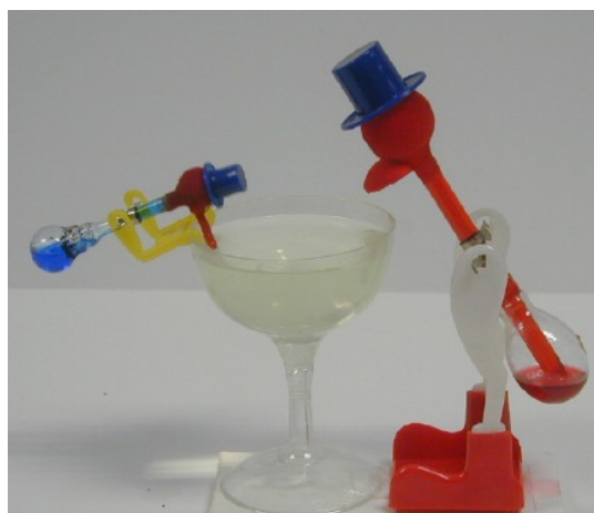
Figura 1. Dos modelos del pájaro bebedor. Cuando la cabeza se moja, el pájaro irá inclinandose hasta perder el equilibrio, llevar su pico hasta el agua, volver a elevarse, oscilar durante algunos instantes, y repetir el ciclo.
