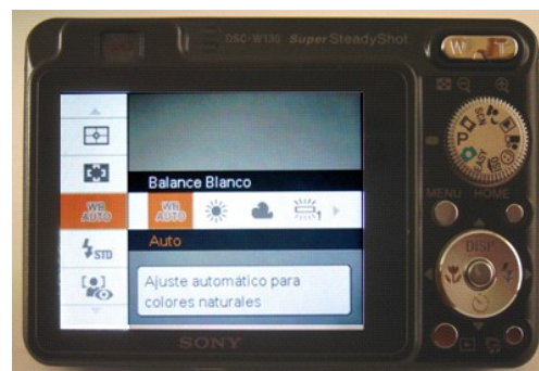
Figura 2.- Menú para selección de balance de blanco de la cámara Sony Cyber-SHOT-DSC-W130 utilizada.
