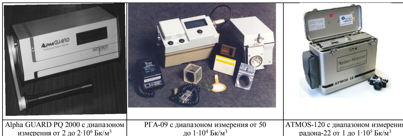
Рис. 3 – Радон-мониторы для измерения объёмной активности радона-222 в атмосферном воздухе хранилищ радиоактивных отходов.
