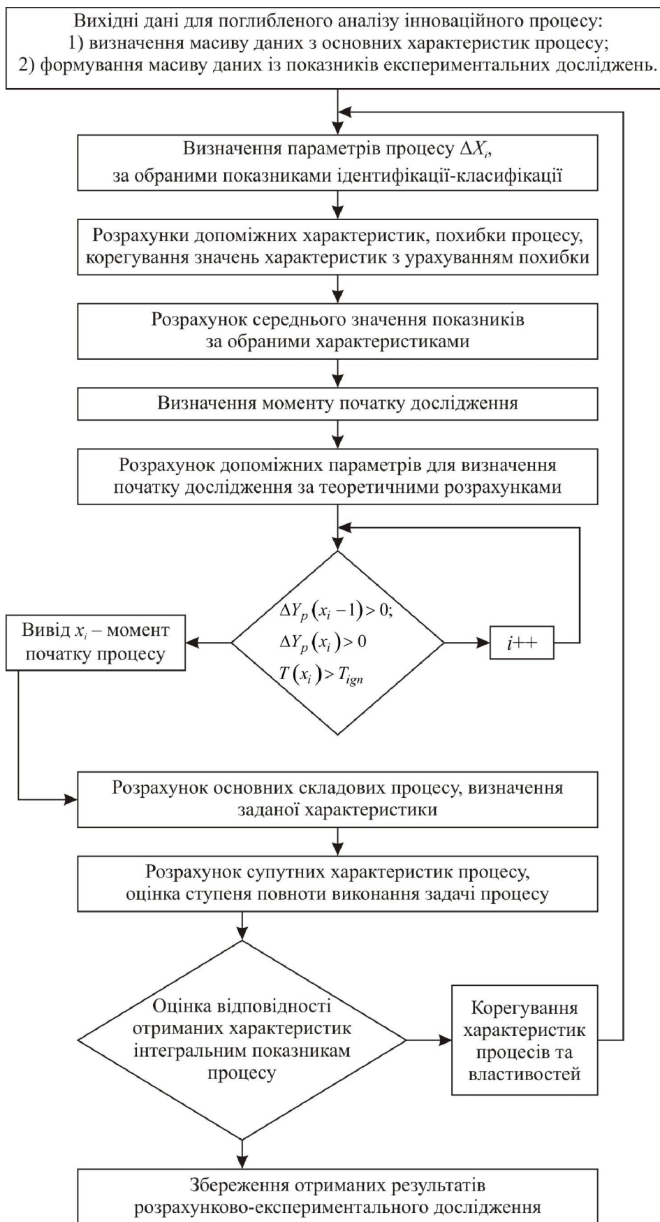
Рис. 2. Загальний алгоритм процесів ідентифікації-класифікації або утилізації-модифікації ТПВ
