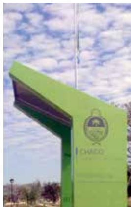
Figura 10. Cargador solar instalado en el Parque de la Democracia y la Juventud de la ciudad de Resistencia, provincia del Chaco. Fuente: elaboración propia
