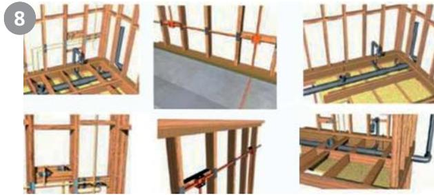
9. Proceso de montaje del Núcleo Administrativo de un Complejo de Cabañas, diseñado para ser materializado mediante un sistema de construcción en seco tipo "steel frame".
