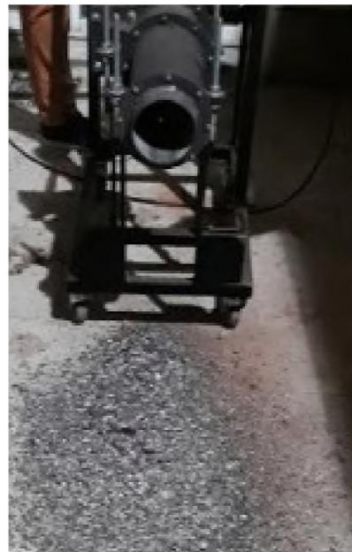
Figura 8 - Cenizas e inquemados
