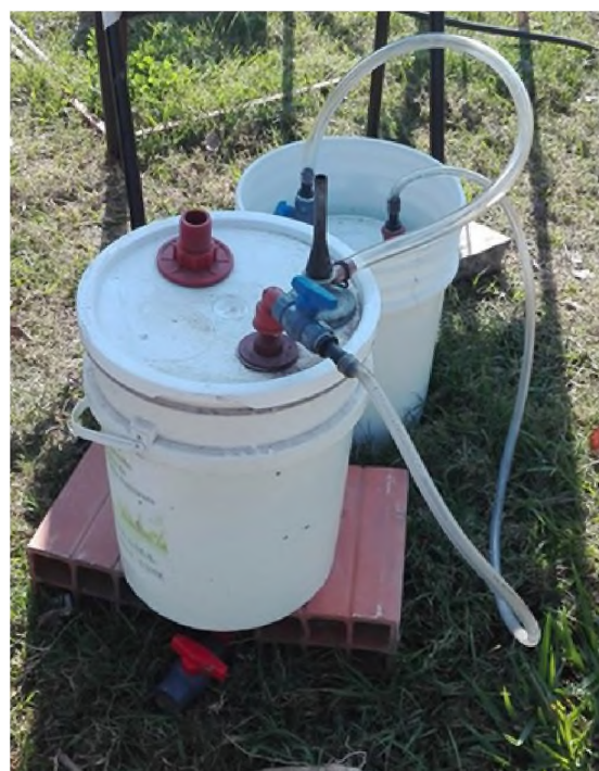
Fig. 5: Comprobación de presencia de metano
