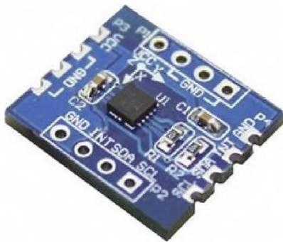
Fig 7. Módulo acelerómetro de Freescale
