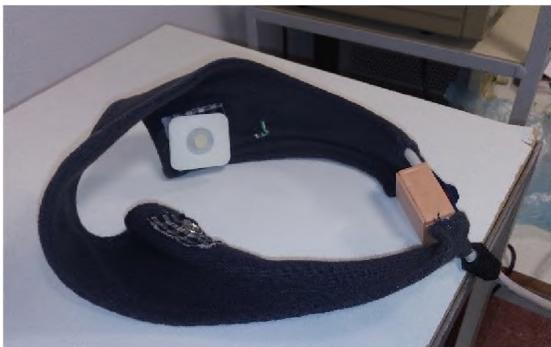
Fig 8. Vincha con los sensores de EoG y movimiento
