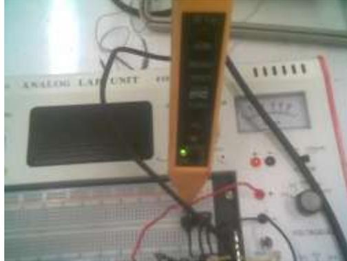
Gambar 4.11. Pengujian IC Dengan Penyidik Logika (*Logic Probe*)
