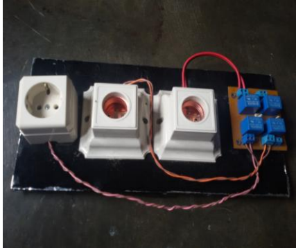
Gambar 5 Bentuk fisik aktuator sebagai keluaran dari sistem mikrokontroler dan saluran untuk beban listrik
