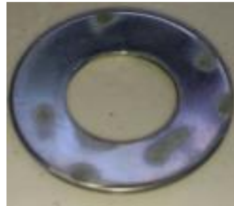
Gambar 8. Visualisasi kegagalan proses electroplating
