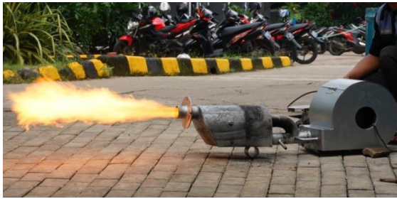
Gambar 5. Foto pengujian burner
