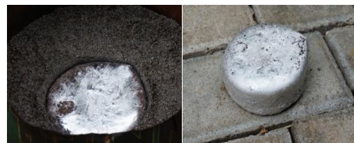
Gambar 10 Aluminium hasil peleburan
