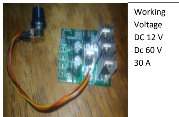
Gambar 18 PWM dan Spesifikasinya
