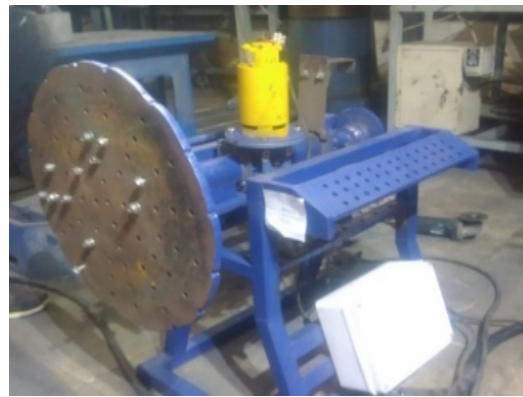
Gambar 12. Positioner Table Posisi Sudut 90^\circ
