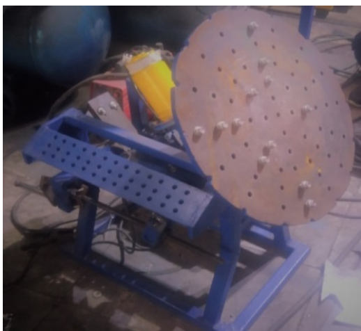
Gambar 11. Gambar Positioner Table Posisi Sudut 45^\circ
