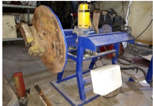
Gambar 17 Pengujian Beban 30 kg sudut 90°
