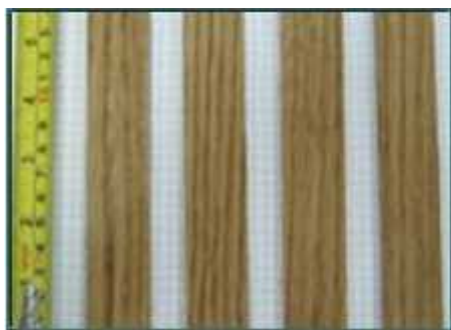
Figura 1. Dimensiones de probetas para ensayo de tracción según norma ASTM D3039.
