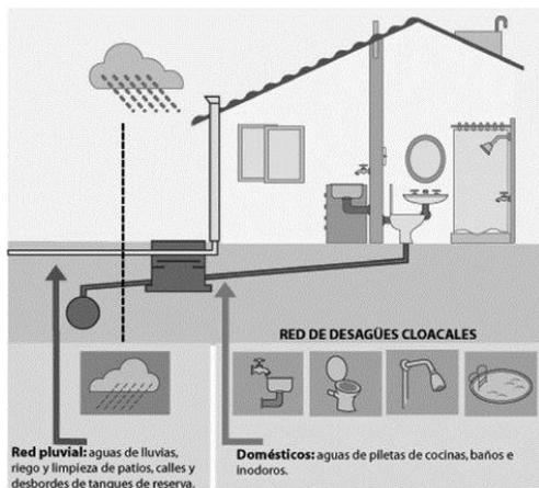
**Figura 7.** Sistema de captación de aguas lluvias.
