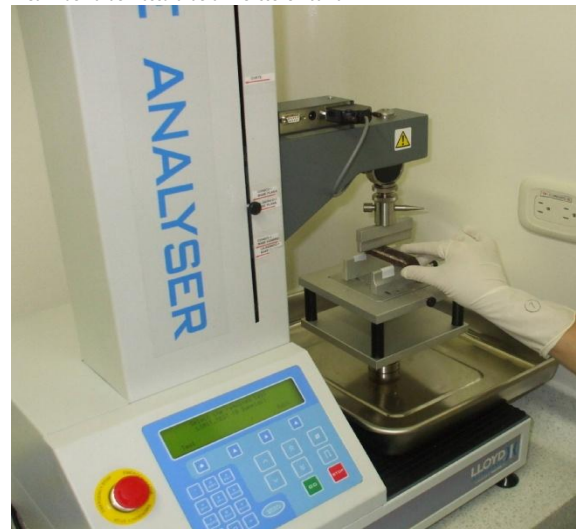
Figura 2. Máquina universal de ensayos de columna sencilla TAPlus serie avanzada (Lloyd Instruments AMETEK Inc. Reino Unido) y accesorio para medir fuerza de fractura de alimentos en barra.
