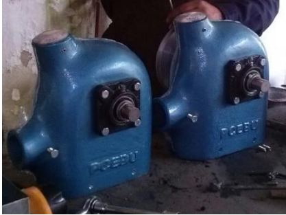
Figura 7. Ensamble de dos carcazas en aluminio. Fuente: Elaboración propia.
