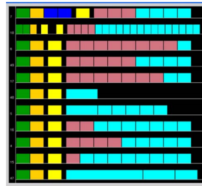
Fig. 3 Esquema del planificador de ráfagas de datos en el tiempo ( Burst Time Plan )
