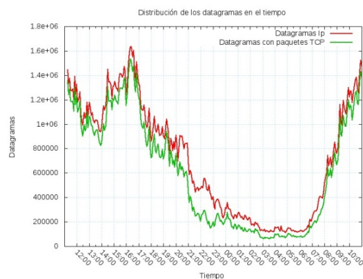
Fig. 10. Distribución de los datagramas que contienen paquetes TCP respecto a los datagramas IP en el periodo de 24 horas: 09-09-2010 11:10 am. a 10-09-2010 11:10 am.
