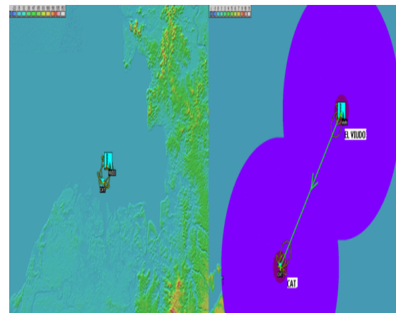
Fig. 5. Simulación del trazado de perfil para evaluar la calidad del enlace inalámbrico UHF
