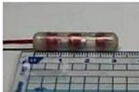
Fig. 5. Prototipo de Capsubot 3.
