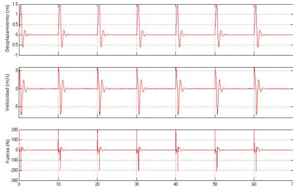
Figura 6. Respuesta de la masa suspendida a una perturbación
