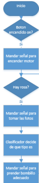
Fig. 4. Diagrama de flujo del prototipo.
